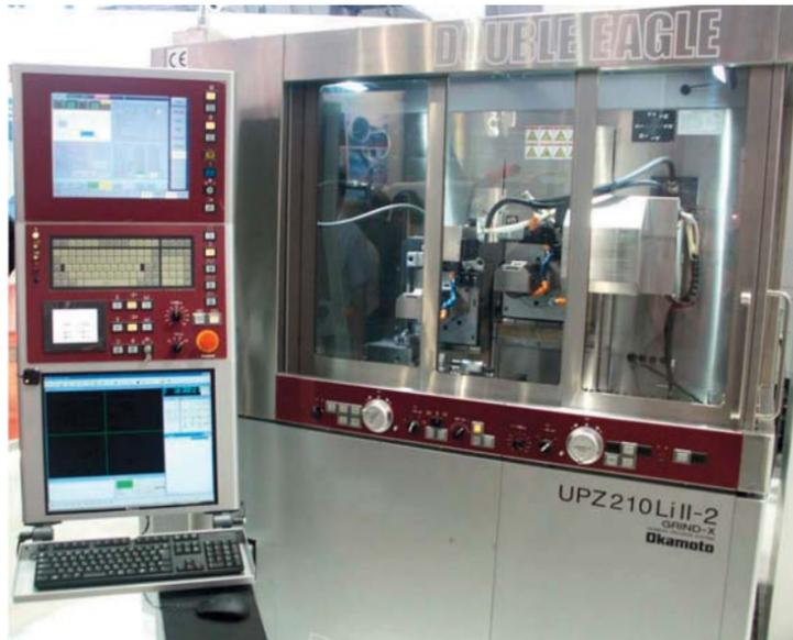
Die UPZ 210 Li II-2 ‚Double Eagle‘ ist ausgerüstet mit zwei Schleifspindeln. Damit entfällt die Notwendigkeit zum Scheibenwechsel beim Vor- und Fertigschleifen. Bild: Okamoto
