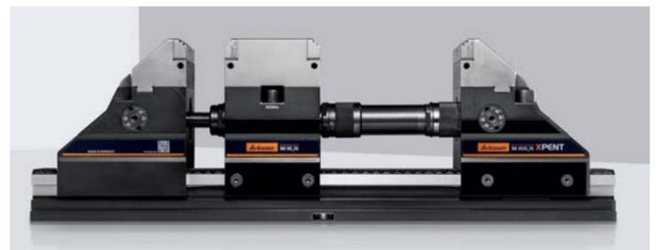
Der 5-Achs-Spanner Garant Xpent ist jetzt mit einer Mittelbacke erhältlich.
