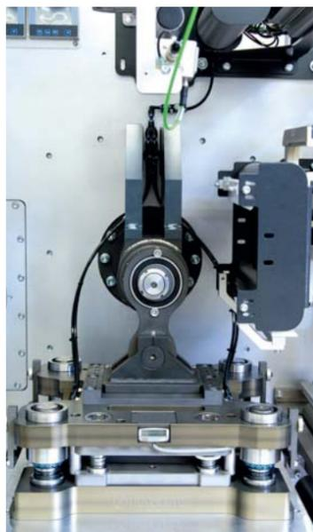
Bestandteil der Standard-Produktionslinie zur Herstellung von laminierten Li-Ion-Pouch-Batteriezellen: Die Highspeed-Notching-Plattform von Manz. Bild: Manz
