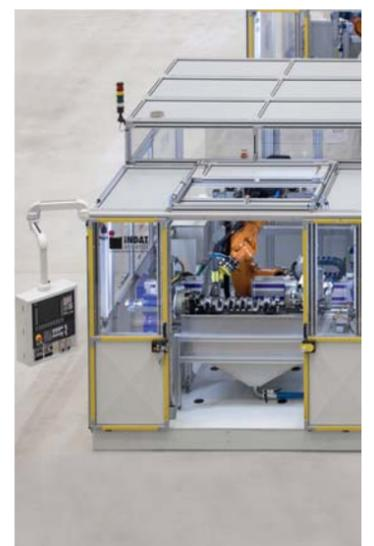
Komplettanlage für das Entgraten und Finishen von Pkw- und Lkw-Kurbelwellen.
