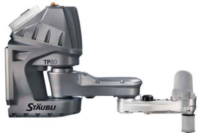
Mit den Optionen HE und H1 wird der Fast Picker TP80 HE zum perfekten Highspeed-Roboter für Verpackungsapplikationen unter Reinraumbedingungen.
