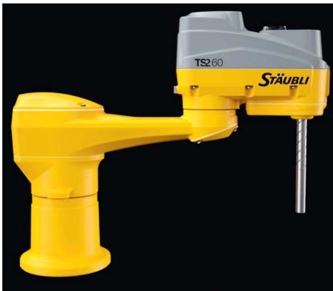
Die neue Scara-Baureihe TS2 ist jetzt modular aufgebaut und verfügt erstmals über die Staubli eigene JCS-Antriebstechnik.
