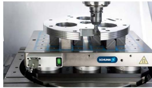
Über die Statusanzeige (hier grün) wird der Spannzustand von Schunk Magnos Quadratpolplatten signalisiert. Bild: Schunk
