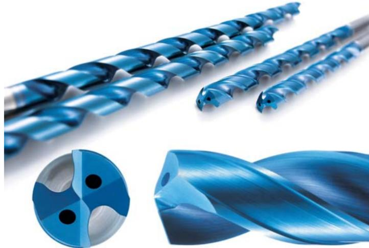
Prozesssicher, produktiv und wirtschaftlich bis 30xD tief bohren: Die beschichteten VHM-Tieflochbohrer Aquadrill Ex Oil-Hole long eignen sich vorteilhaft für die Serienfertigung von Ölbohrungen in Kurbelwellen. Bild: Nachi
