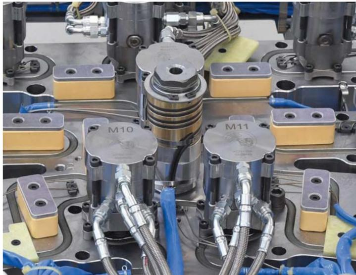
Die neuen, als Pressure Blocks bezeichneten Druckplatten von HRSflow bestehen aus Materialien mit sehr geringer thermischer Leitfähigkeit.
