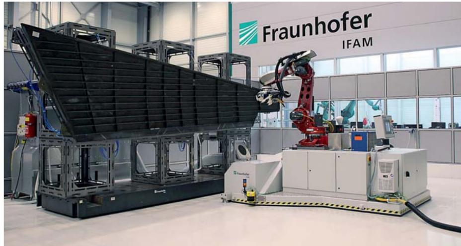
Der mobile Roboter bearbeitet das Seitenleitwerk eines Airbus 320.
